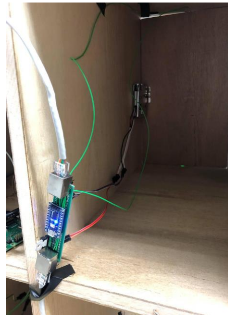
圖 7、自動取書櫃子設備，串聯的 STM8S 單位和電控鎖。
