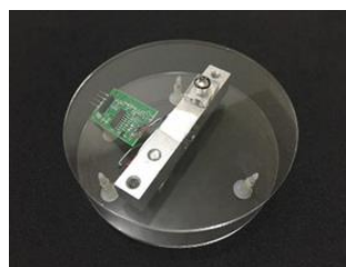
圖 12 HX711+壓力感測器
